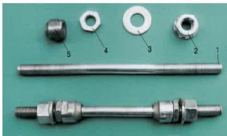
Hình 24.1. Cấu tạo cụm trục trước xe đạp 1. Trục ; 2. Đai ốc ; 3. Vòng đệm ; 4. Đai ốc hãm côn ; 5. Côn.
