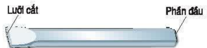
Hình 21.3. Cấu tạo đục
